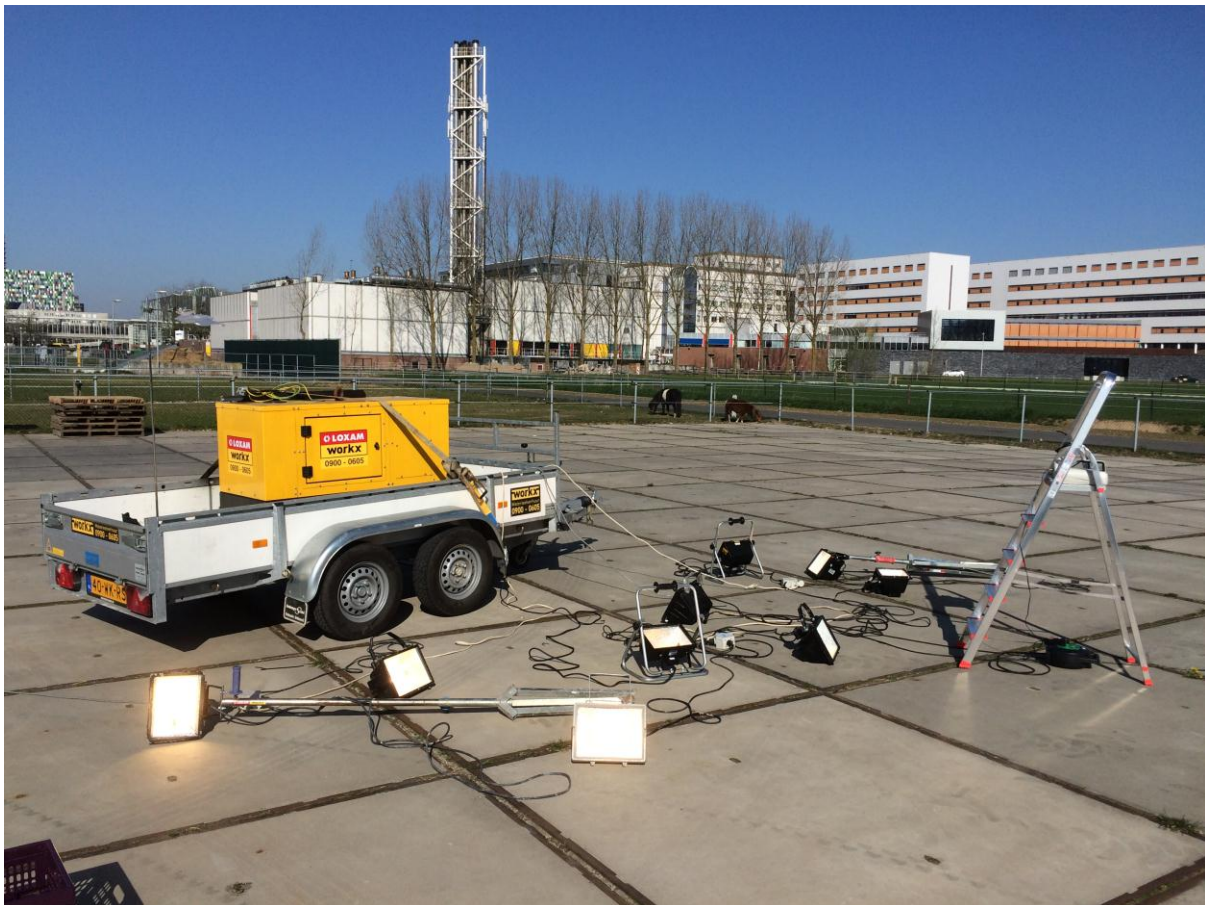
Figuur 2 Opzet bron en meetapparatuur (op een ladder geplaatst) bij Scenario I .
