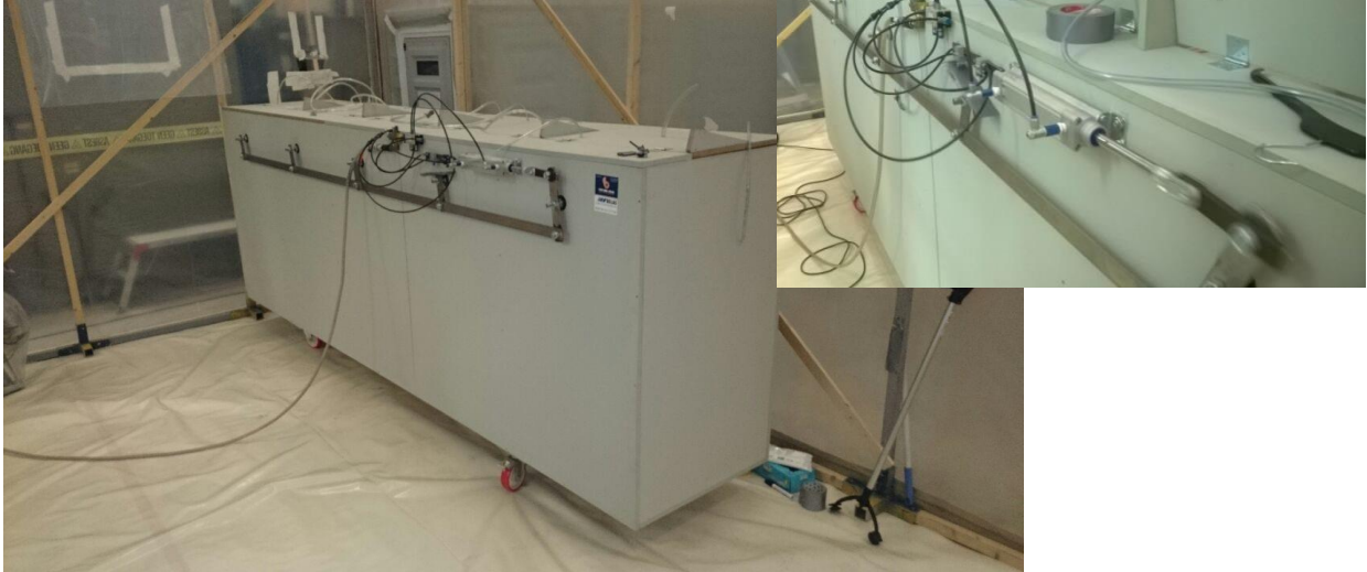
Afbeelding 3 Achterzijde van gekoppelde kasten met pneumatische klopmechanisme. De inzet is een vergrote weergave van het klopmechanisme.
